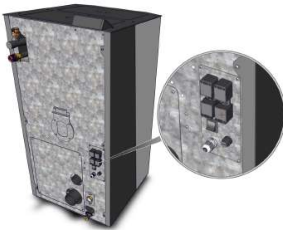
Slika 26. Prikaz pozicije kablovske uvednice, glavnog prekidača kao i sigurnosnog termostata
