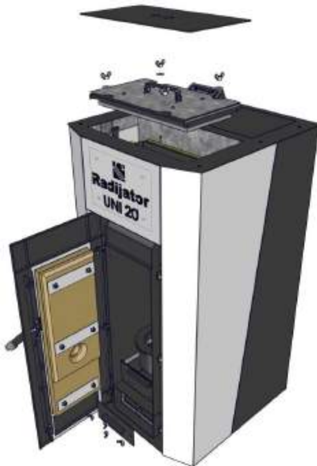
Slika 29. Prikaz elemenata koji se rasklapaju prilikom čišćenja
