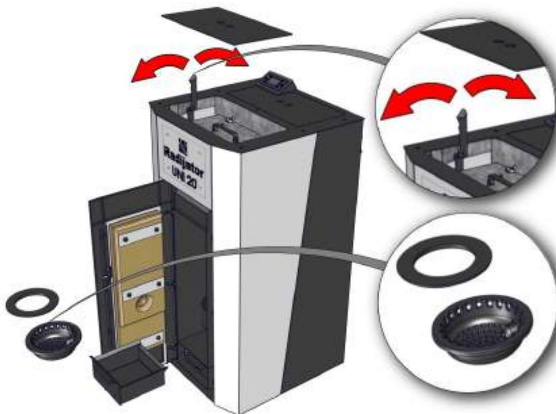
Slika 28. Čišćenje solje za sagorevanje i turbulatora
