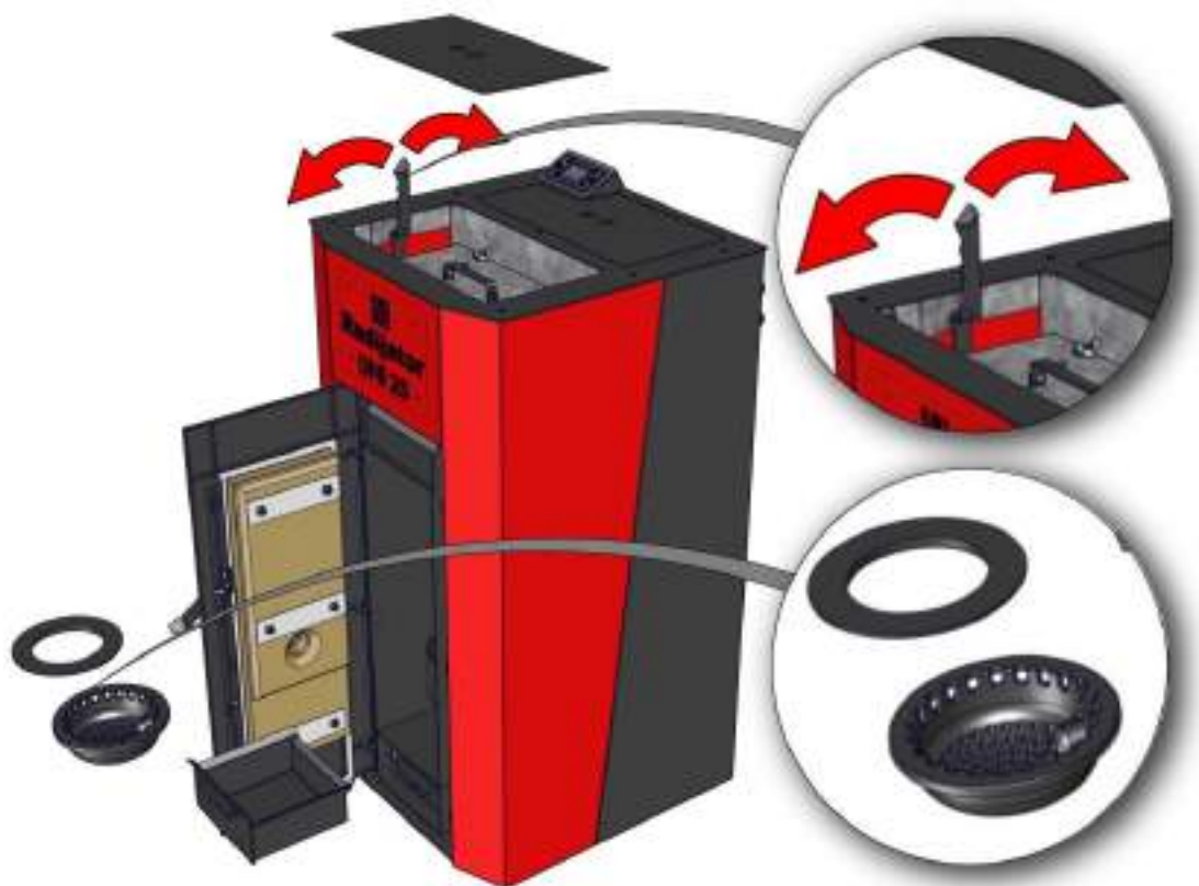
Slika 28. Čišćenje solje za sagorevanje i turbulatora
