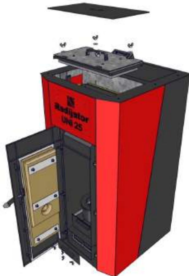
Slika 29. Prikaz elemenata koji se rasklapaju prilikom čišćenja
