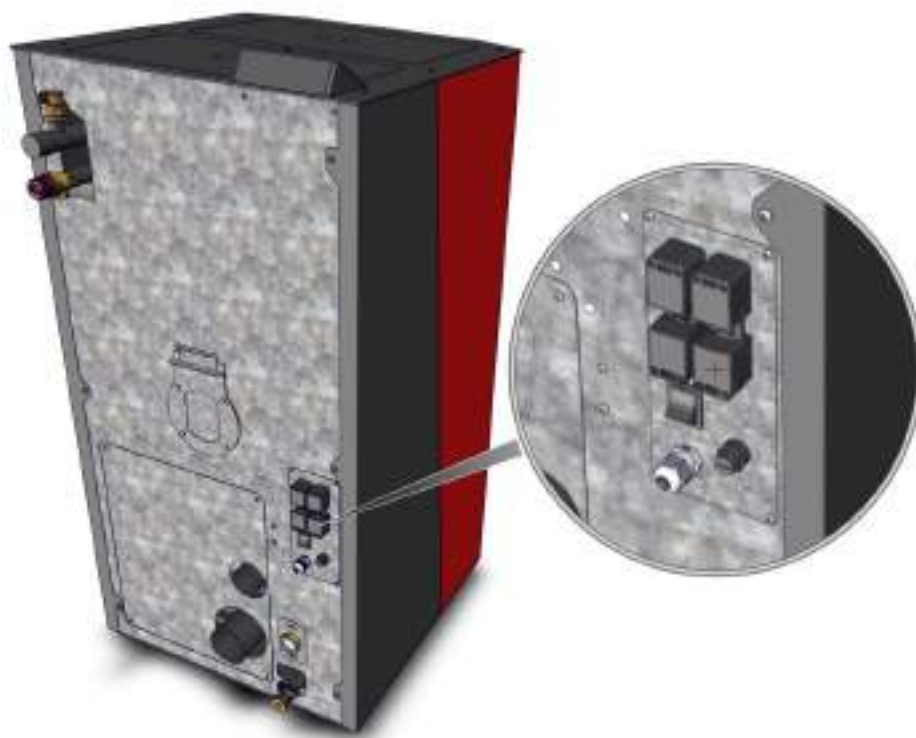
Slika 26. Prikaz pozicije kablovske uvodnice, glavnog prekidača kao i sigurnosnog termostata
